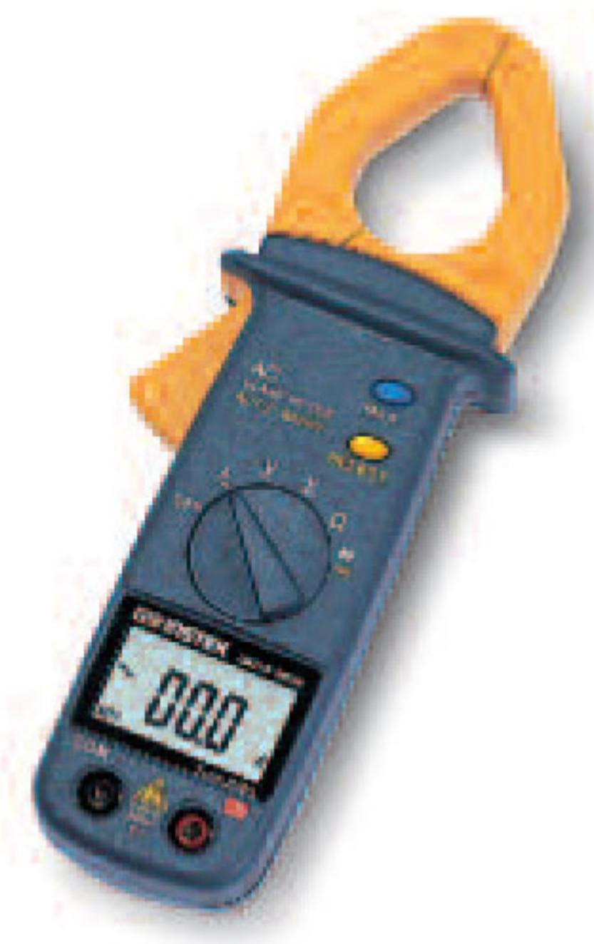
GCM-302/303시리즈는 중소형 사이즈의 케이블 측정을 겨냥한 클램프형 전류계입니다. 최대 600V, 600A의 넉넉한 입력과 멀티미터의 일반적인 기능을 보유하여 단선없이 전류측정은 물론 다기능적인 측정이 모두 가능합니다. 오토레인징, 자동전원꺼짐 및 Max.Hold 및 Maximum 로드등의 편의기능을 제공합니다. 특히 GCM-303은 실효치 측정이 가능하여 기능성이 더욱 강한 제품입니다.
