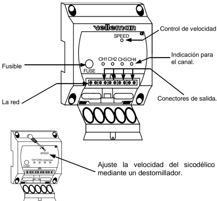
Ajuste la velocidad del sicodélico mediante un destornillador.
